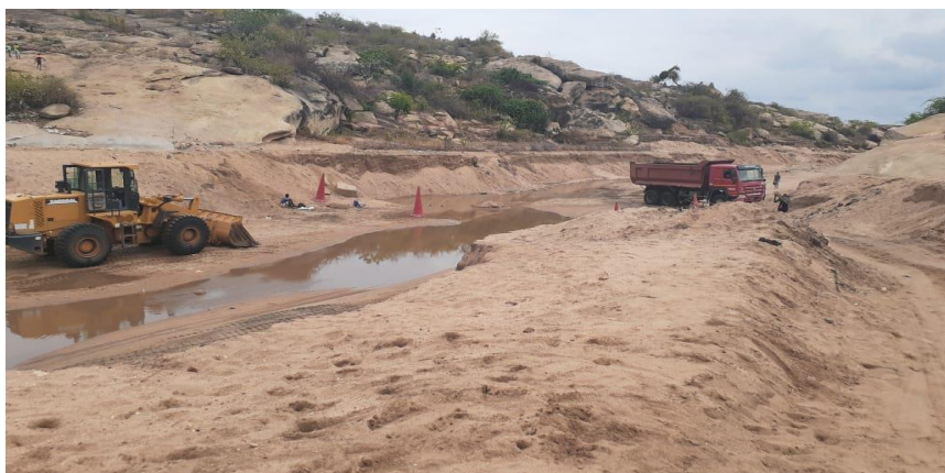
Fotografia 4: Extracção de areia por pá-escavadeira e camião basculante
